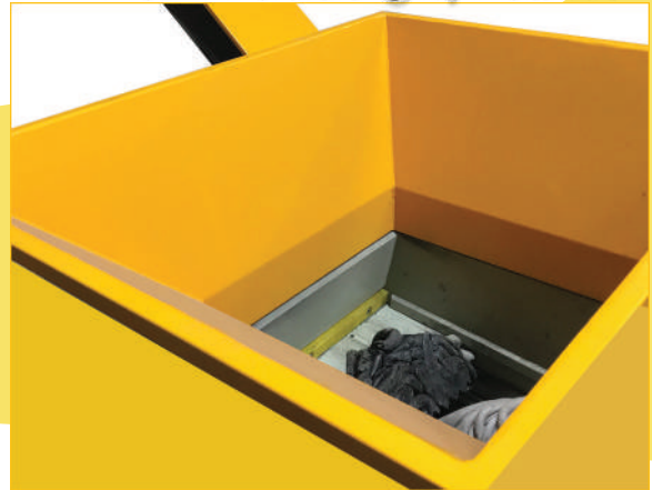
Raw material inlet hopper Hammadde giriş haznesi
